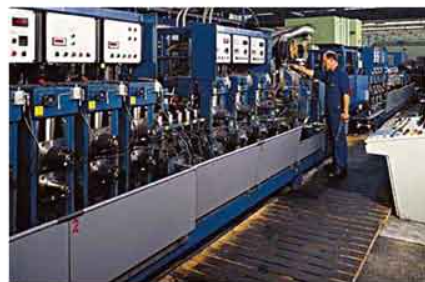
Impianto che utilizza rulli formatori in Ampco 25 nella produzione di tubi in acciaio inossidabile. (qui sopra: stazione di saldatura)
