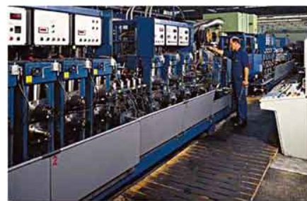
Instalación que empela rodillos matriz de Ampco 25 para la producción de tubos de acero inoxidable. (arriba: estación de soldadura)
