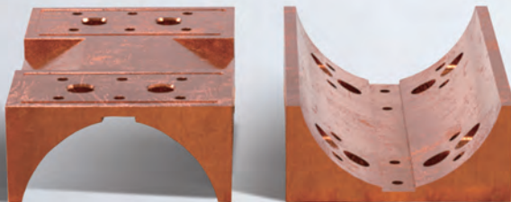
Placas de contacto: utilizadas en hornos de aleaciones de hierro, con canales de refrigeración. Fabricadas en cobre-Zinc (85% - 15%) o en cobre puro de alta conductividad
