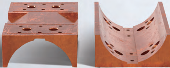
接触板： 在铁合金熔炉中使用，配有冷却水道。 可由铜锌合金 (85% - 15%) 或高导电的纯铜 制成
