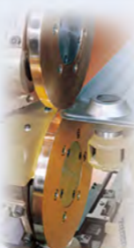
Soldagem por resistência
