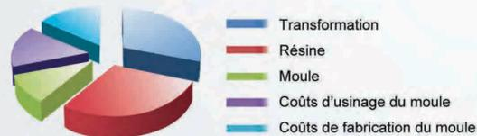
**Le coût AMPCO des matériaux pour un moule à haute performance thermique est minime par rapport aux coûts d'une pièce plastique. Avec AMPCO® le fabricant de moule et le transformateur de matière plastique feront des économies de coûts substantielles :**
