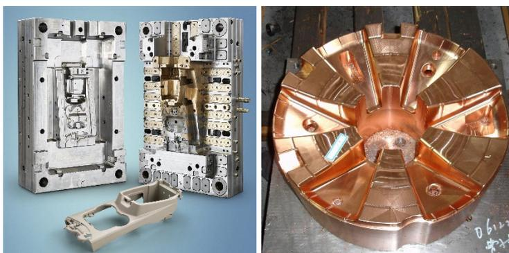
AMPCOLOY® 95 findet dank seiner außergewöhnlichen Eigenschaften ein breites Spektrum an Anwendungen. Es wird vor allem für Schweißelektroden für Edelstahl, Monel® und Nickellegierungen verwendet. Aufgrund seiner hervorragenden Wärmeleitfähigkeit ist es auch für Kolbenspitzen in Aluminiumdruckgussmaschinen und Kühleinsätze im Kunststoffformenbau von großem Nutzen.
